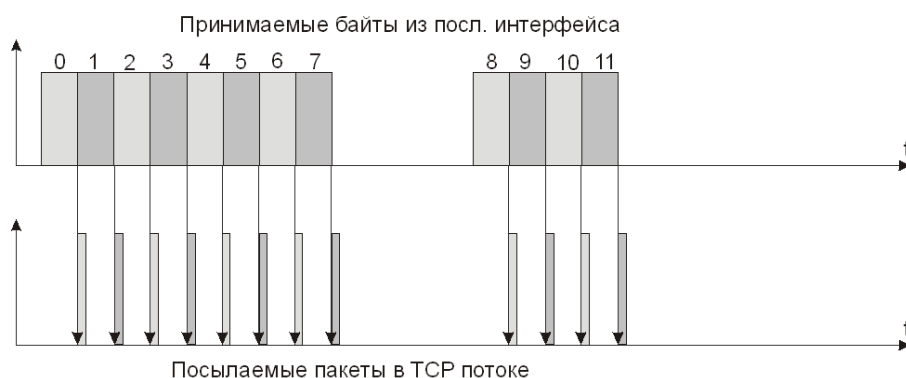
Рисунок 24 - Избыточный трафик по сети Ethernet
